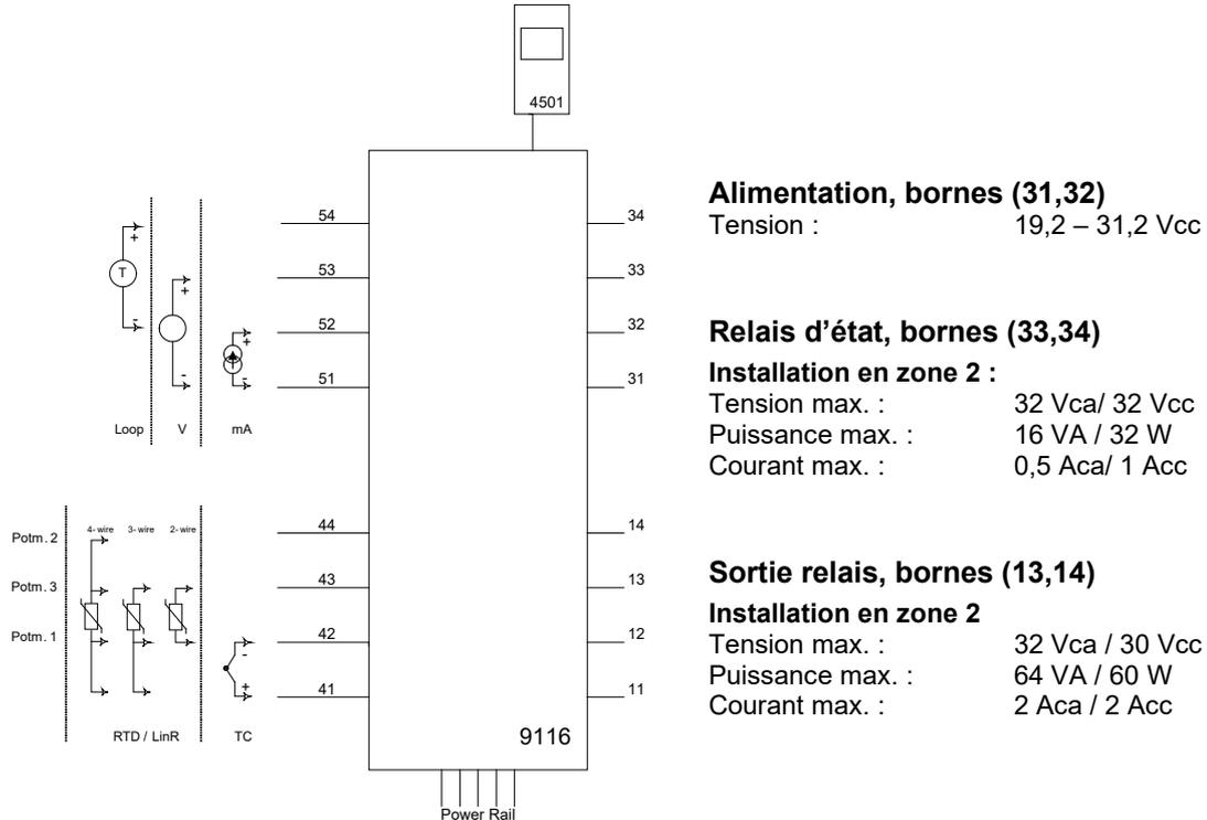
Pour l'installation dans la zone 2, le module doit être installé dans une enceinte externe ayant une protection de type Ex e, assurant une protection d'étanchéité au moins d'IP54. Les raccords de câble et les bouchons doivent remplir les mêmes exigences.
